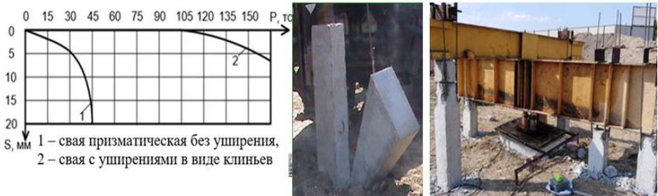
Рисунок 6 - График зависимости осадки от вертикального нагружения свай с уширениями в виде сборных клиньев (слева), погружение свай и клиньев (в центре) и статические испытания (справа)
