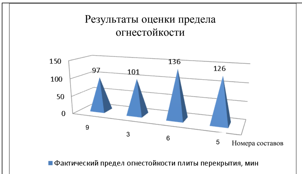
Рисунок 7- Фактический предел огнестойкости плиты перекрытия с защитным слоем из штукатурного раствора: 9) контрольный, 3) без волокон, 6) с 0,5% волокон, 5) с 3% волокон
