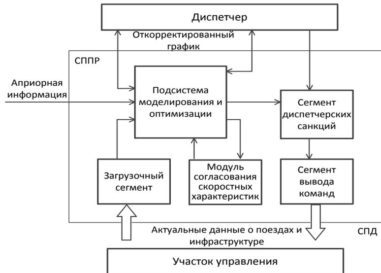
Рисунок 5.2 - Архитектура и внешние связи СППР поездного диспетчера
