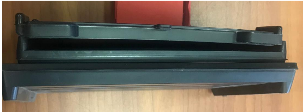
Рисунок 1.28 – Подрельсовые прокладки разной толщины
