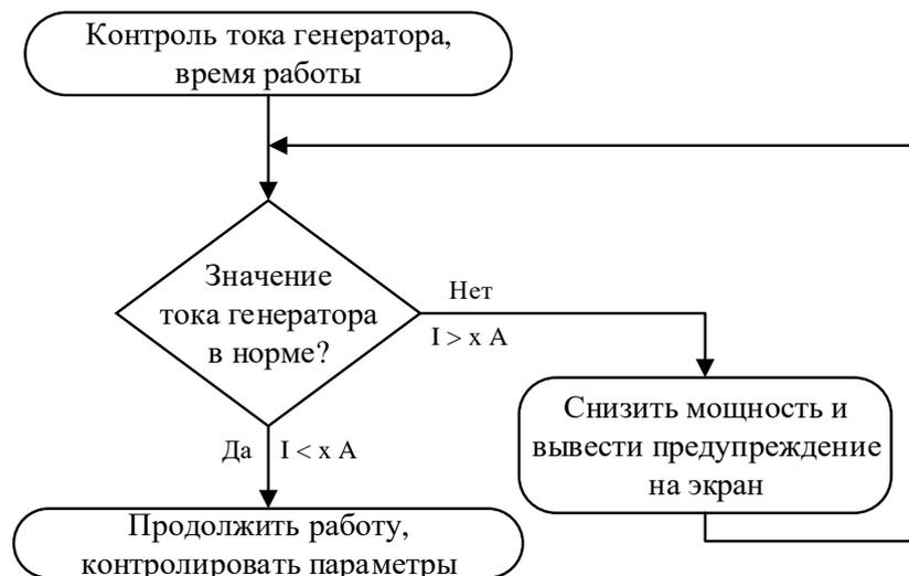
Рисунок 4.12 – Блок-схема алгоритмической защиты
