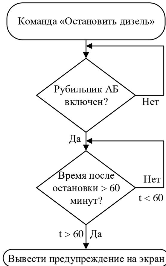
Рисунок 4.13 – Блок-схема алгоритмической защиты
