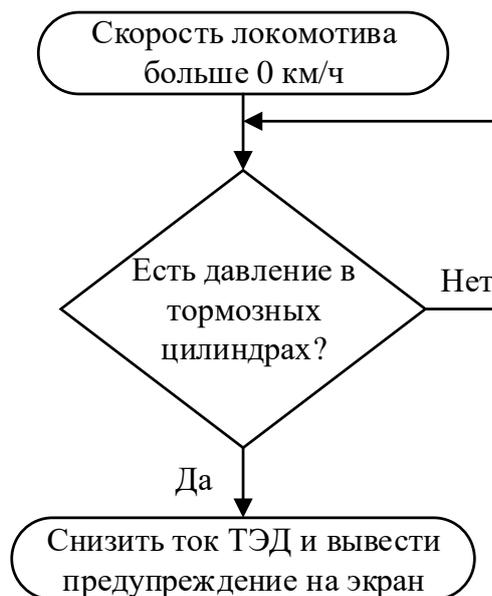
Рисунок 4.15 – Блок-схема алгоритмической защиты
