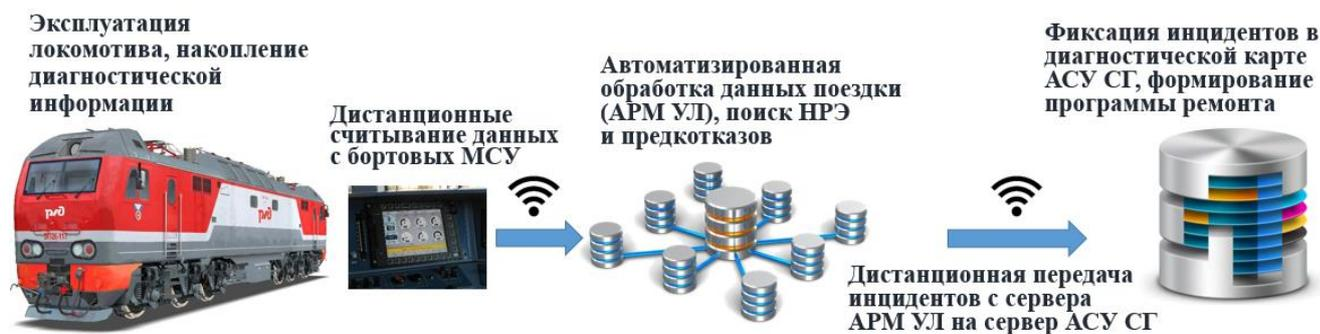
**Рисунок 2.3 – Предлагаемая схема обработки диагностических данных, накопленных в бортовых микропроцессорных системах управления**
