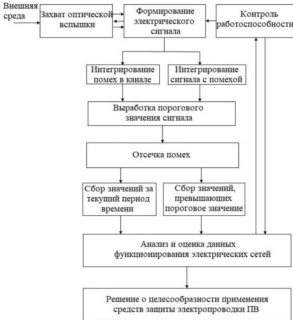
Рисунок 3.2 — Функциональная схема составной части СОЗЭС, обеспечивающего обнаружение по интенсивности в видимом диапазоне оптического излучения
