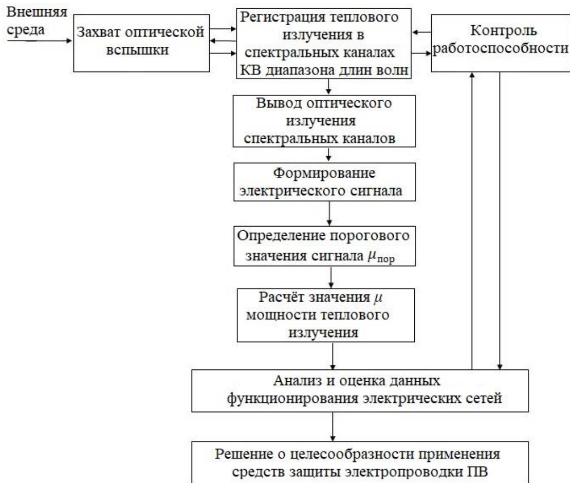
Рисунок 3.3 — Функциональная схема составной части СОЗЭС, обеспечивающего обнаружение оптического излучения по спектральному составу в инфракрасном диапазоне
