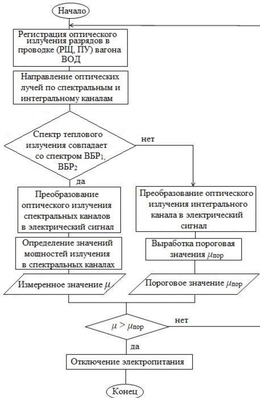
Рисунок 3.10 — Обобщённый алгоритм функционирования подсистемы обнаружения по спектральному составу в инфракрасном диапазоне длин волн
