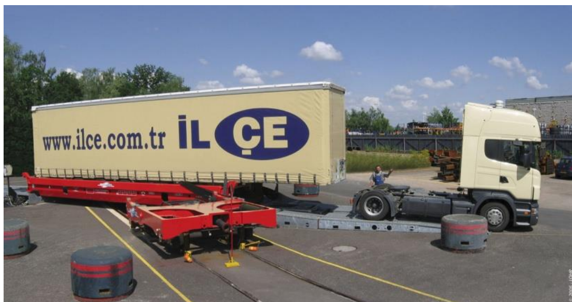
Рисунок 1.10 – Погрузка прицепа на платформу
