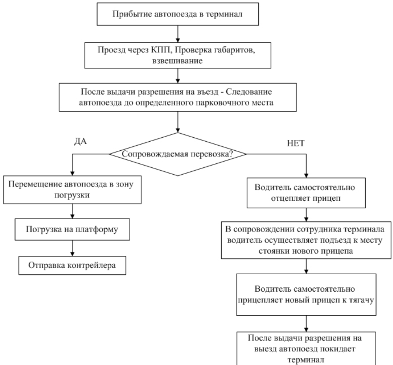
Рисунок 2.3 – Схема перемещения автопоезда с последующей заменой прицепа
