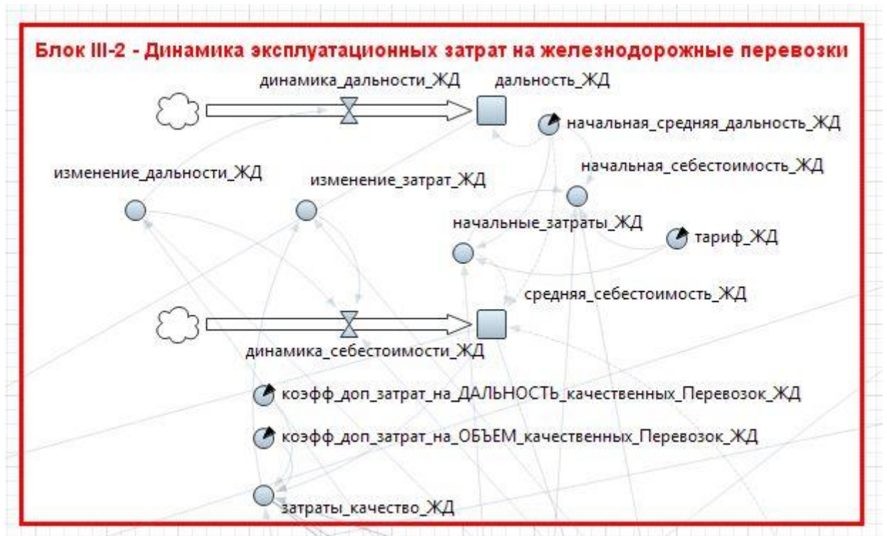
Рисунок 3.7 – Структура блока модели, имитирующего динамику эксплуатационных затрат на железнодорожные перевозки
