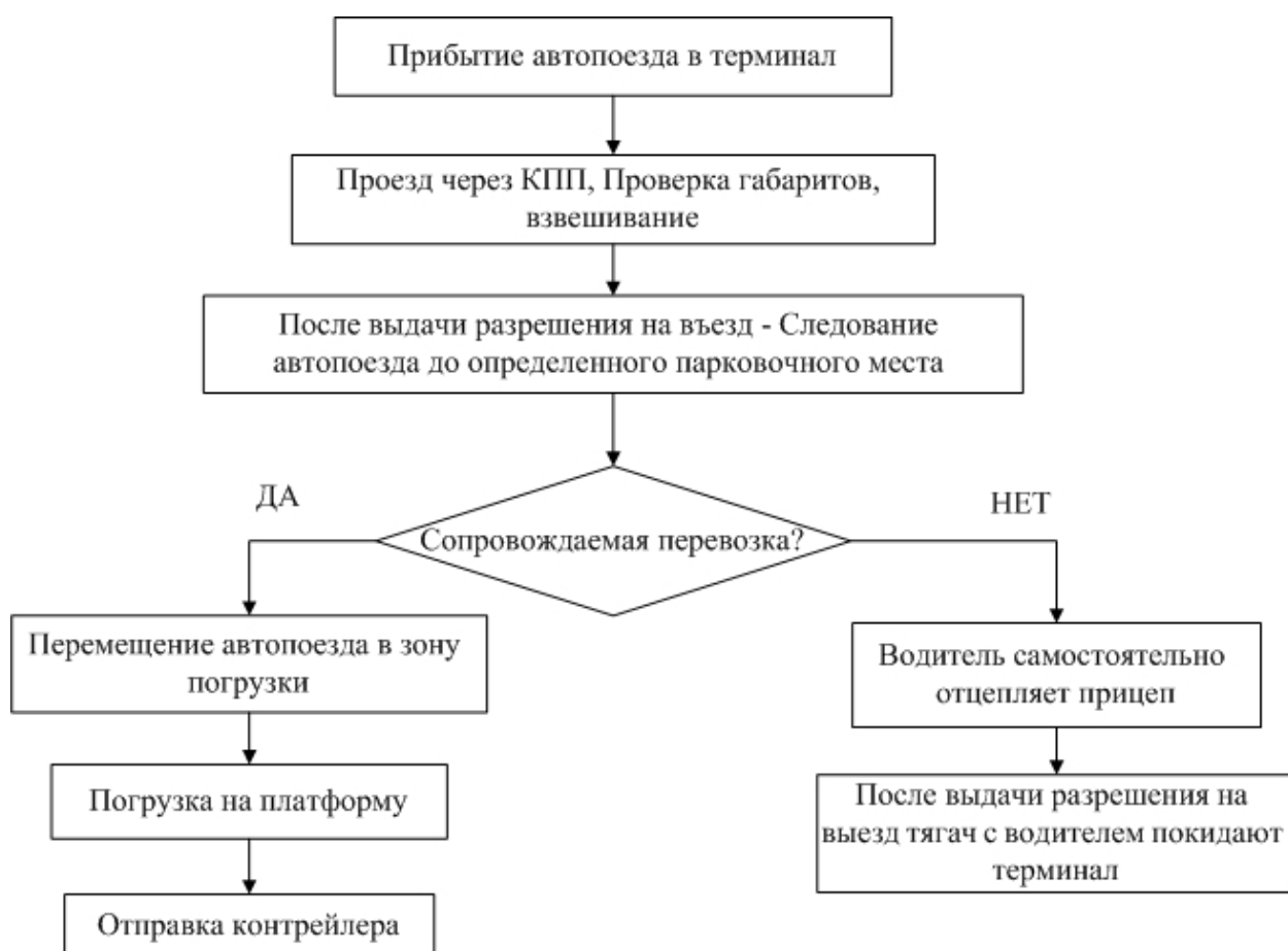
Рисунок 2.4 – Схема перемещения автопоезда с последующим отправлением тягача без прицепа
