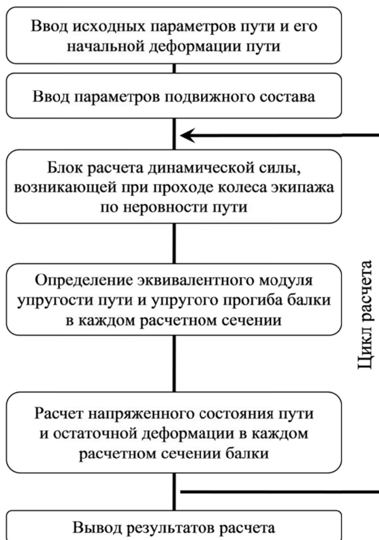
Рисунок 2.6 – Укрупненный алгоритм расчета воздействия подвижного состава на путь по разработанной методике
