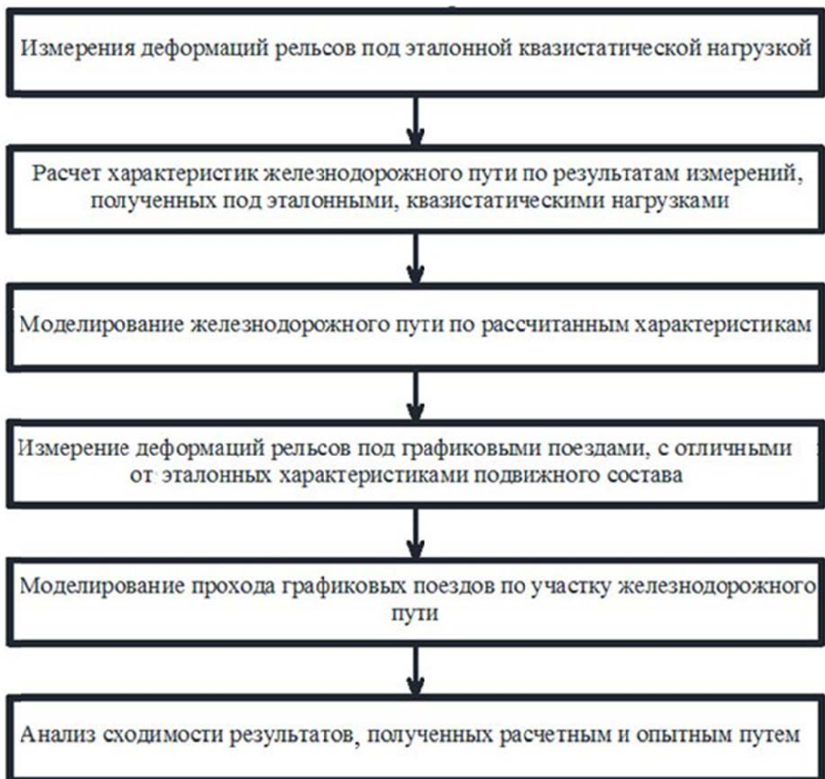
Рисунок 2.8 – Структурная схема проверки адекватности модели
