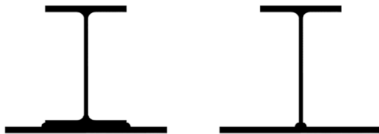
Рисунок 3.2 – Сечение пояса фермы в виде несимметричного двутавра
