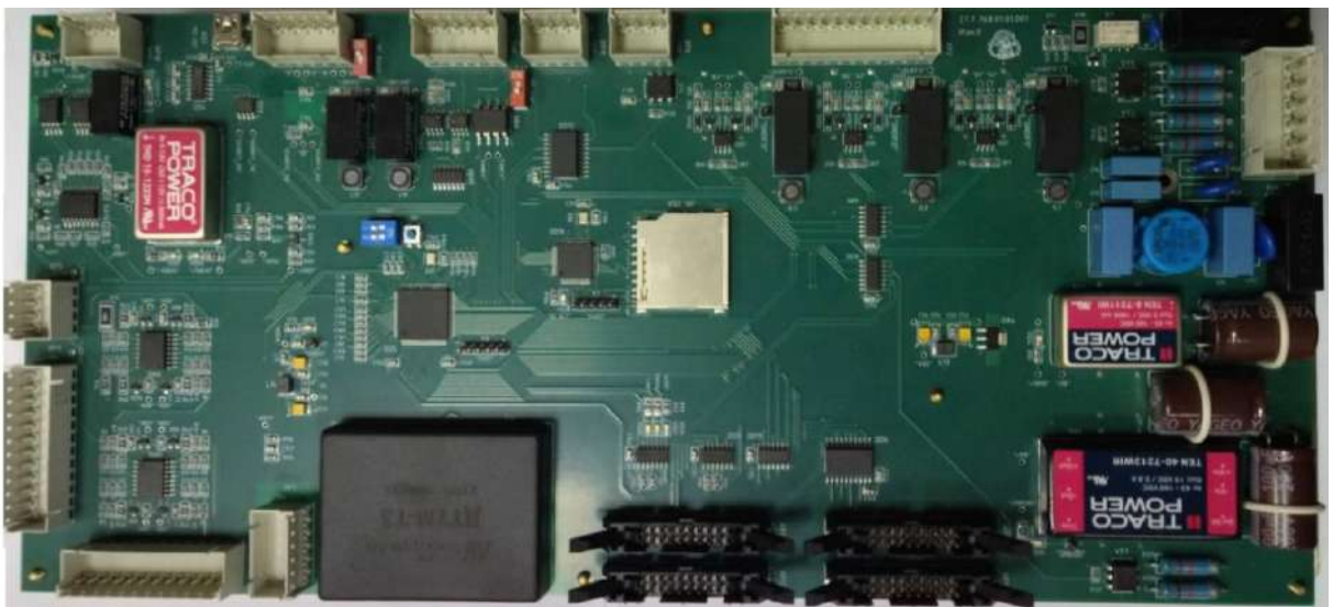
Рисунок 6.4 – Внешний вид платы управления
