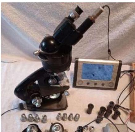
Рисунок 2.5 – Поляризационно-интерференционный микроскоп BIOLAR
