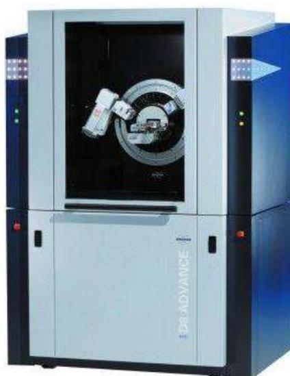
Рисунок 2.4 – Дифрактометр D8 ADVANCE для определения фазового состава продуктов новообразований цементного камня
