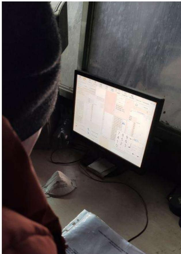
Рисунок Д.3 – Заполнение в окне программы технолога состава внедряемой бетонной смеси
