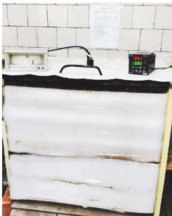
Рисунок 2.2 – Пропарочная камера КПУ-1М для ТВО бетонов
