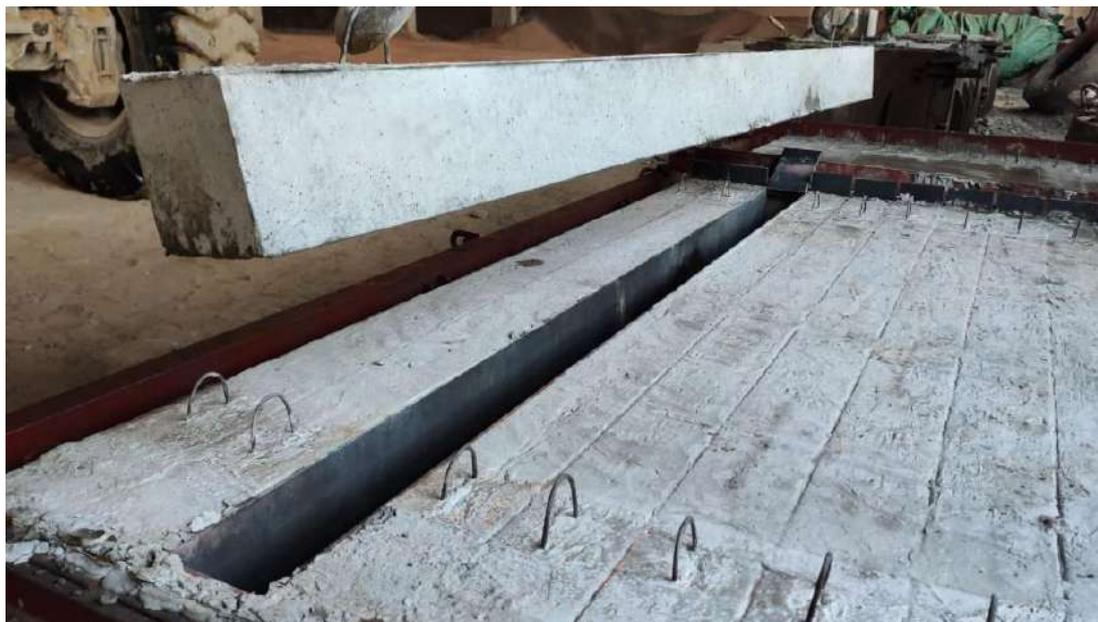
Рисунок Д.7 – Готовые железобетонные перемычки после твердения по режиму (1+6+2) ч
