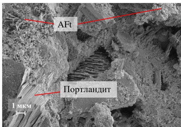
Рисунок 3.33 – СЭМ-изображение образца с ПКЭ при 5000-кратном увеличении
