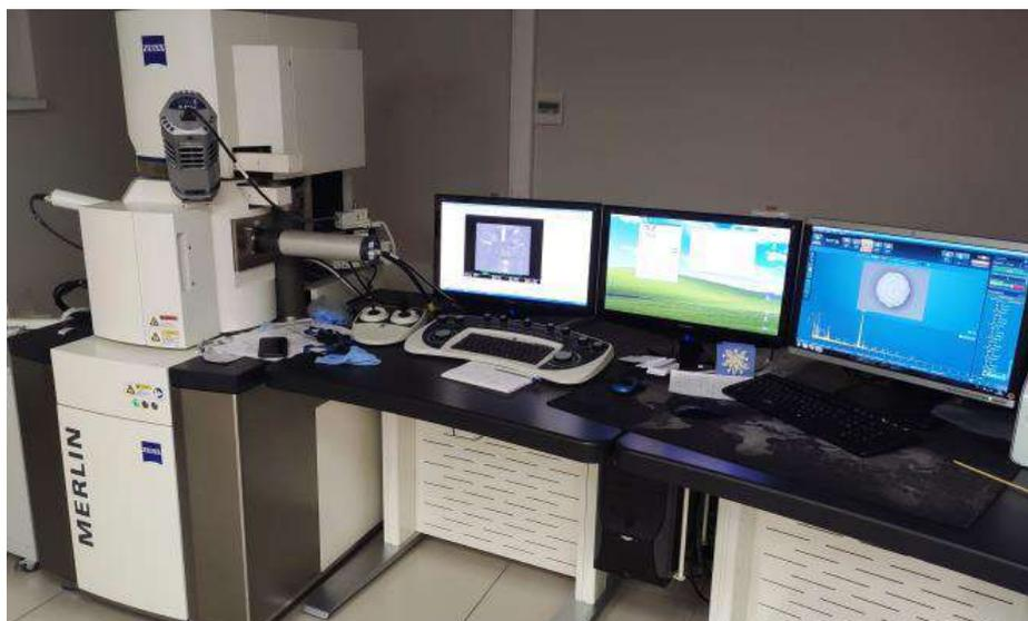
Рисунок 2.6 – Сканирующий электронный микроскоп Merlin (компании CARL ZEISS)
