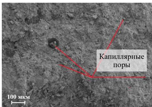
Рисунок 3.24 – СЭМ-изображение образца с ПКЭ при 100-кратном увеличении
