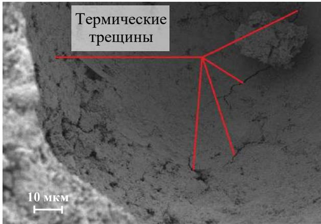
Рисунок 3.26 – СЭМ-изображение образца без добавок при 1000-кратном увеличении. Иллюстрация трещин в порах
