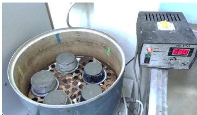
Рисунок 2.1 – Выдерживание модифицированных цементных паст в камере ТС-100 при 40 °С
