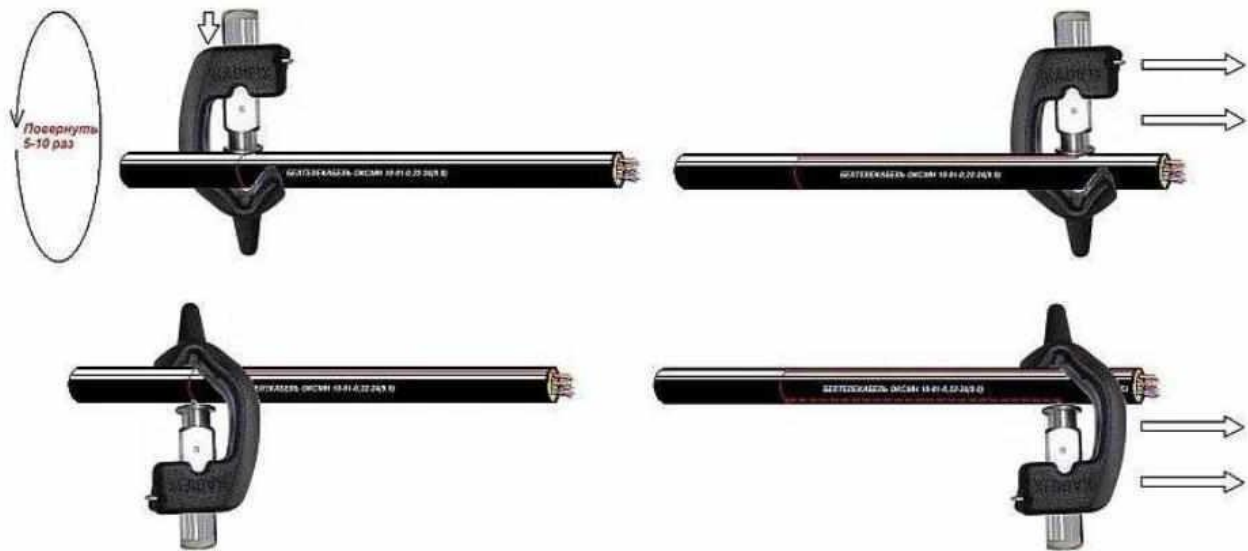
Рисунок 6 – Снятие внешней оболочки кабеля ножом-стриппером
