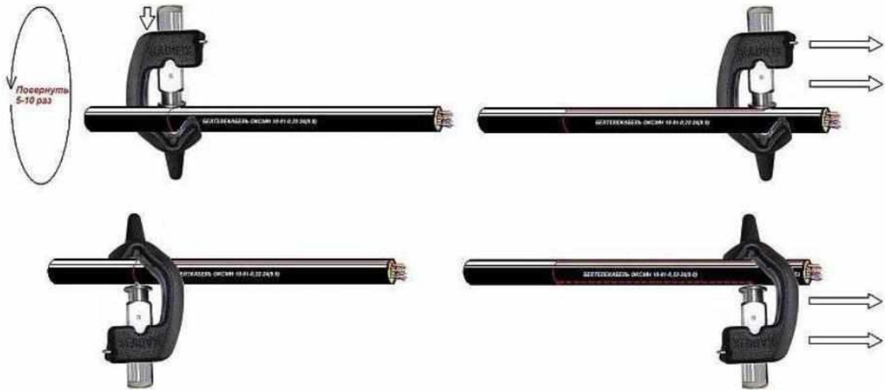
Рисунок 6 – Снятие внешней оболочки кабеля ножом-стриппером
