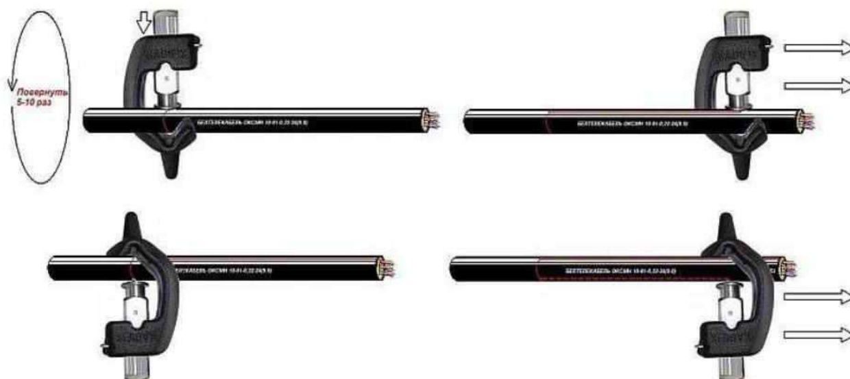
Рисунок 6 – Снятие внешней оболочки кабеля ножом-стриппером
