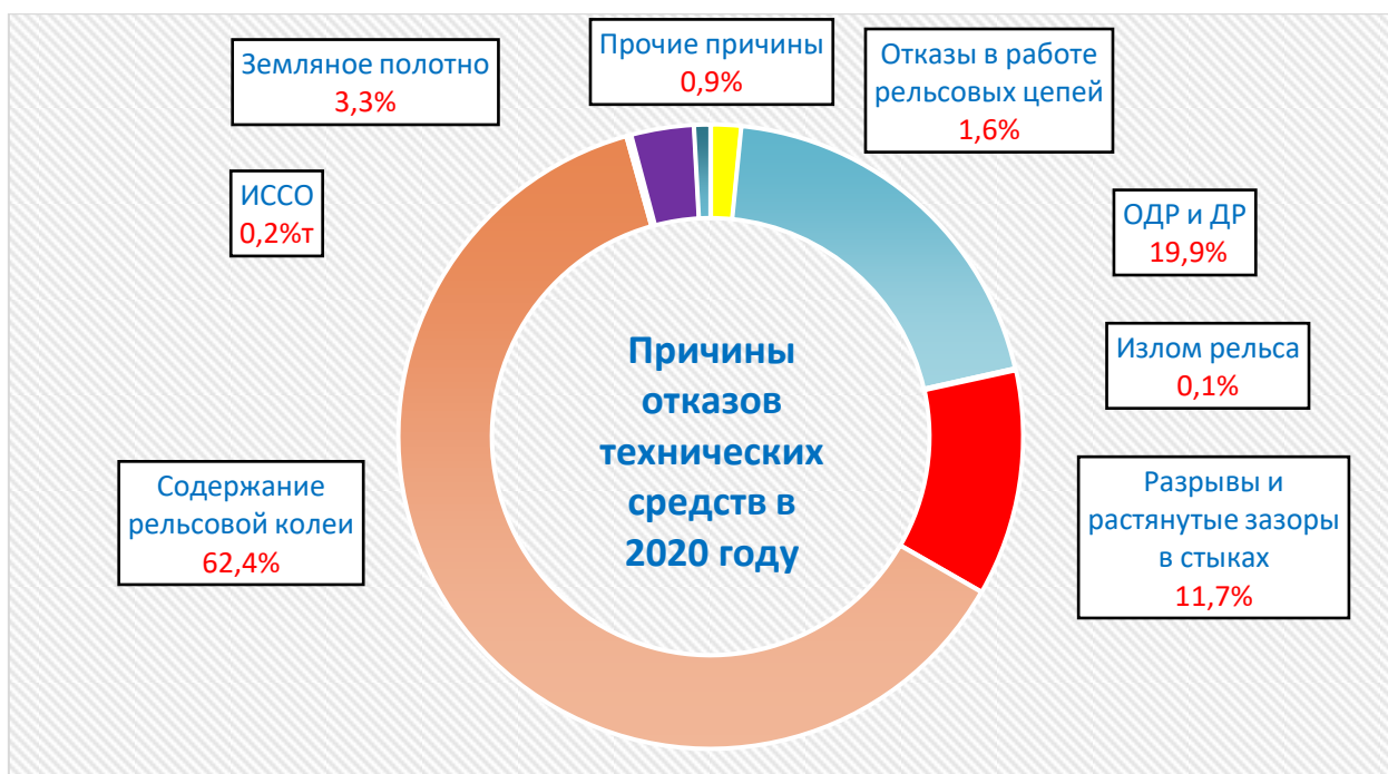
Рисунок 4.9 - Причины отказов технических средств в 2020 г. на сети железных дорог
