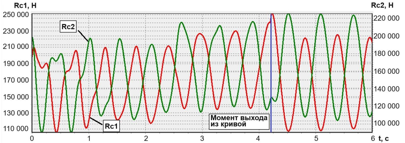
Рисунок 4.6 - Зависимость вертикальных реакций рессорных комплектов от времени при длине кривой 105 метров
