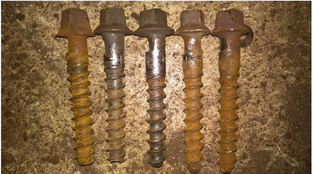
Рисунок 1.7 – Путевые шурупы длиной 150 мм с повышенным износом (до 8 мм).
