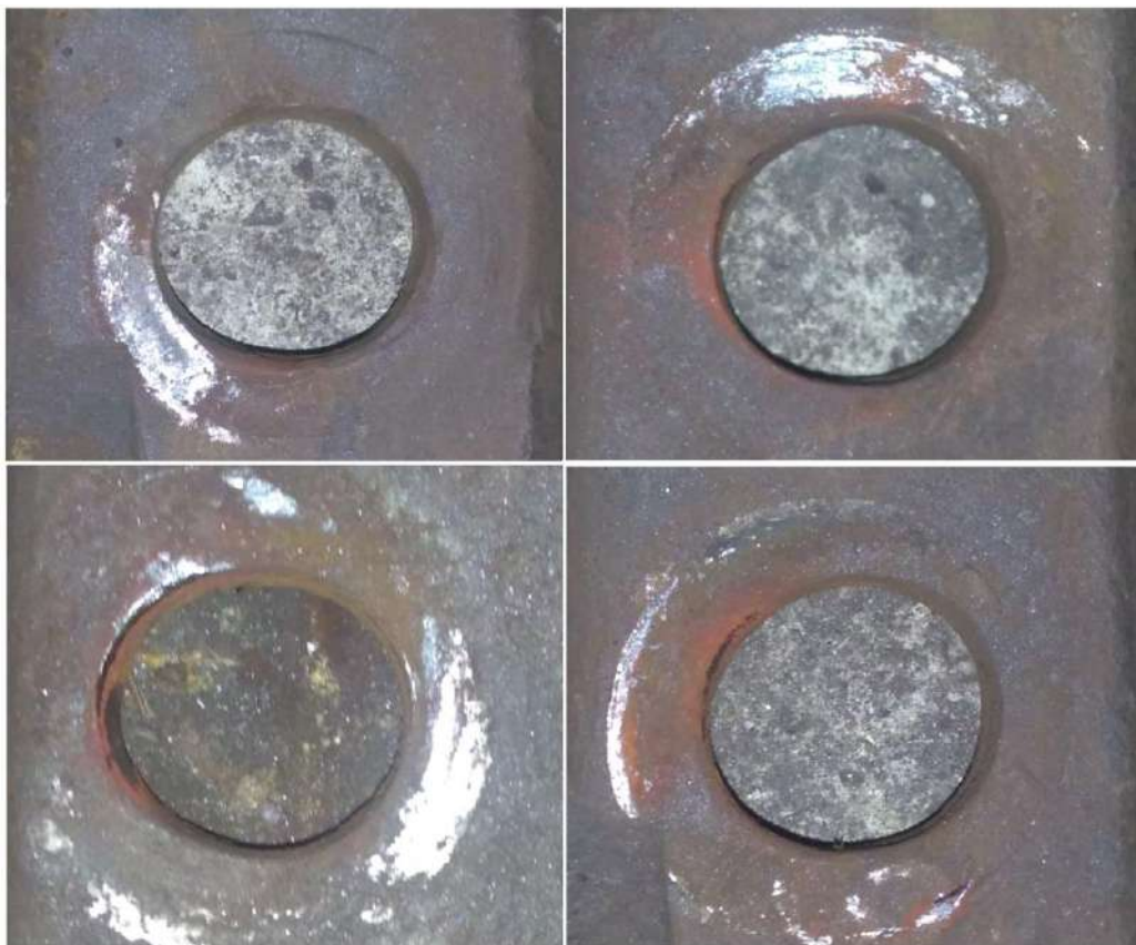
Рисунок 1.8 – Овалообразный износ отверстий в подкладках типа «метро»
