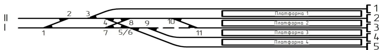
Рисунок 6 - Фрагмент схемы произвольной пассажирской станции с 5-ю перронными путями (схема №3)
