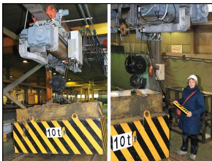
Рисунок 9 – Статические испытания крана мостового, специального, однобалочного, грузоподъемностью 10 т для ОИАЭ. Удержание краном поднятого груза 12,5 т
