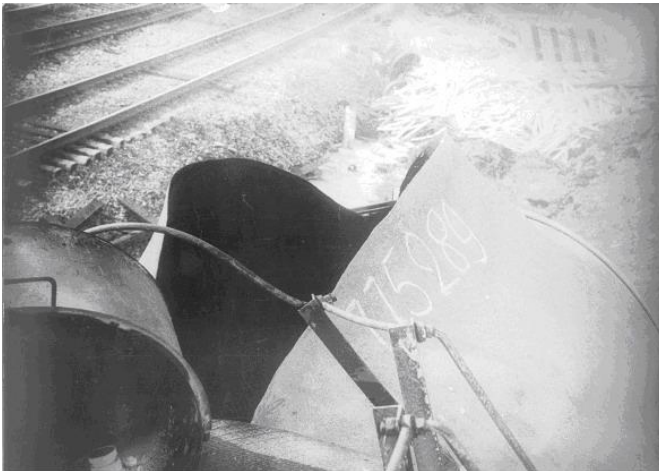
Рисунок 1 – Последствия нахождения котла цистерны в очаге пламени
