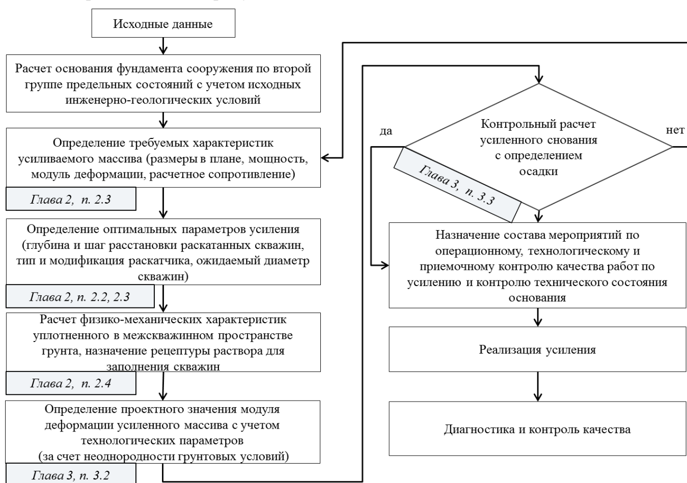
Рисунок 12 – Алгоритм проектирования усиления грунтов набивными сваями в раскатанных скважинах
