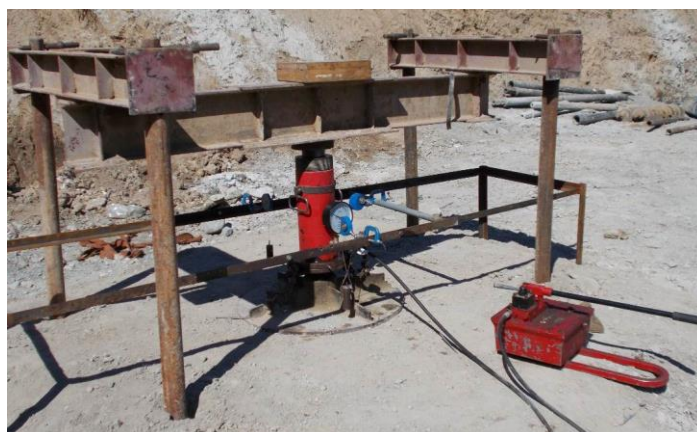
Рисунок 4 – Установка штампового испытания
