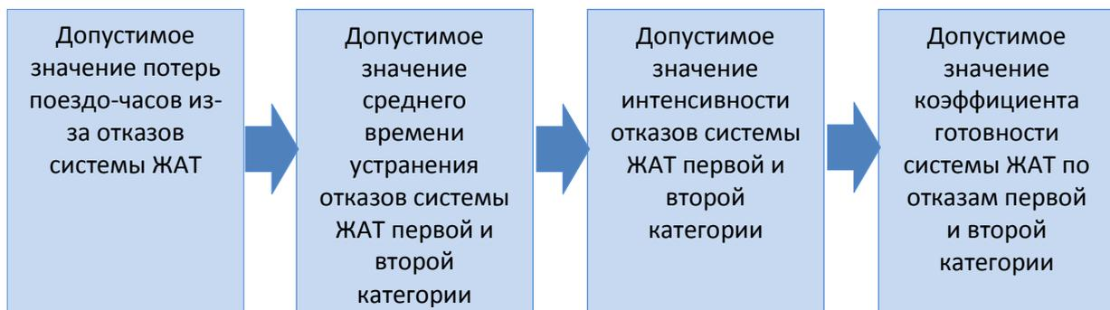
Рисунок 3 – Последовательность нормирования показателей функциональной надежности систем ЖАТ
