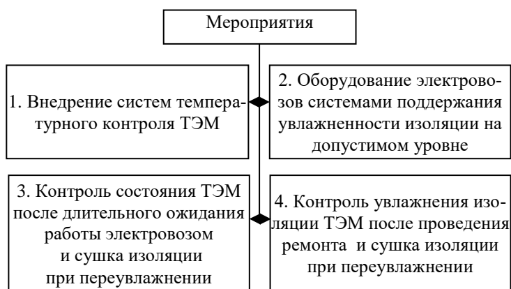
Рисунок 14 - Мероприятия по предотвращению выдачи на линию электровозов с переувлажненной изоляцией ТЭМ
