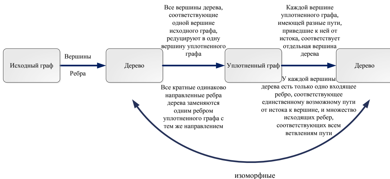
Рисунок 2 – Возможность получения из уплотненного графа дерева, содержащего все возможные последовательности заполнения или освобождения указателей ночной расстановки на станции
