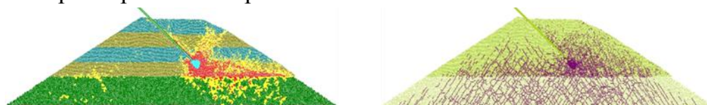
Рисунок 23 – Инъецирование твердеющего раствора
