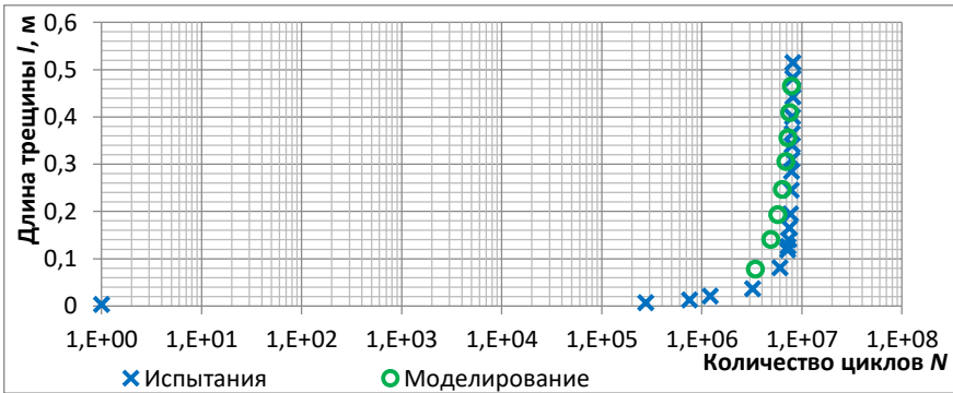
Рисунок 6 – Диаграмма зависимости количества циклов нагружений до достижения критической длины трещины цельнокатаного колеса
