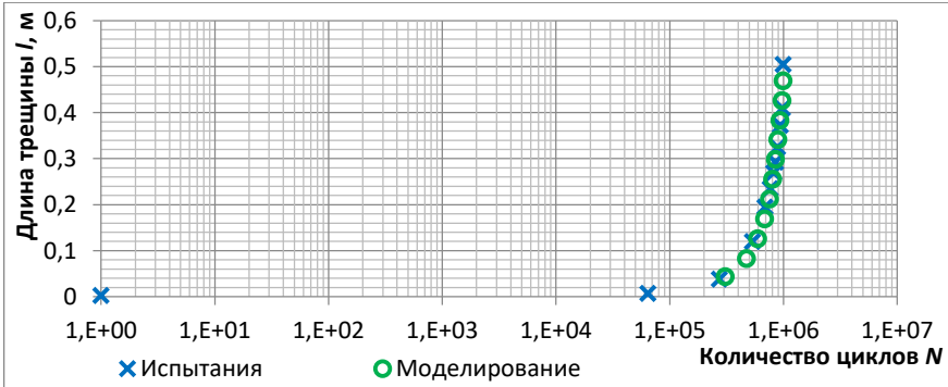
Рисунок 5 – Диаграмма зависимости количества циклов нагружений до достижения критической длины трещины литого колеса
