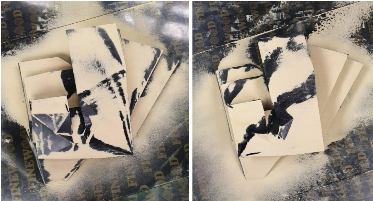
Рисунок 18 – Характерные зоны снеговых отложений, углы набегающего потока 0^{\circ} (С) и 270^{\circ} (В)
