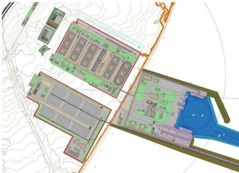
Рисунок 19– План размещения пылезащитных экранов
