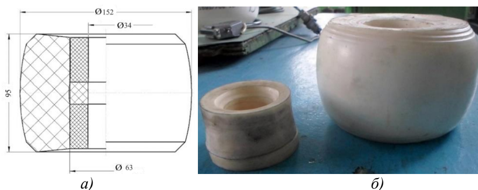
а – эскиз полимерного элемента; б – фотография полимерного элемента
