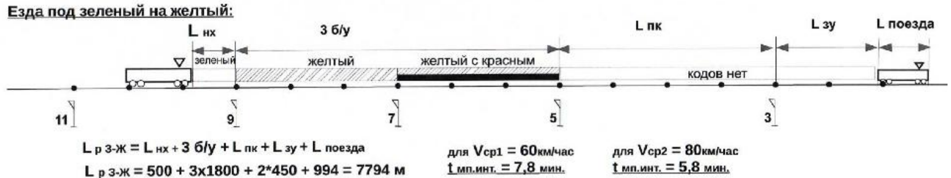
Рисунок 2.20 – Пример построения кривой торможения. Фактическая скорость локомотива в момент проезда светофора с желтым показанием 65 км/ч, допустимая скорость 22 км/ч.
