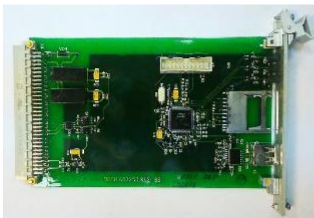
Рисунке 3.4– Внешний вид ячейки регистратора АЛСН
