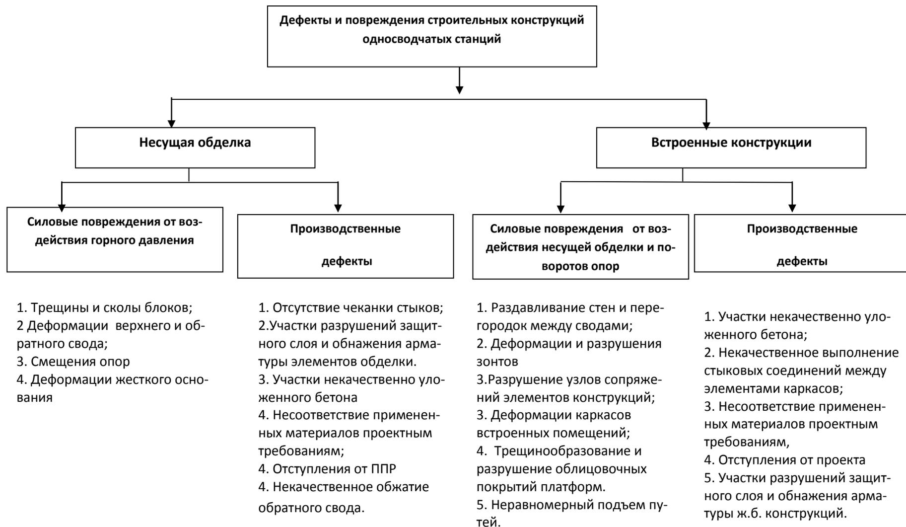
Рисунок 2.15 – Классификация дефектов и повреждений строительных конструкции односводчатых станций
