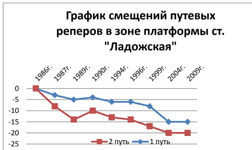
Рисунок 4.1 – График смещений путевых реперов в зоне платформы «Ладожская»
