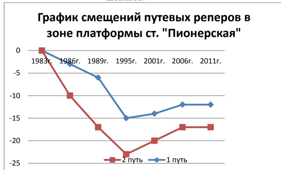
Рисунок 4.3 – График смещений путевых реперов в зоне платформы станции «Пионерская»
