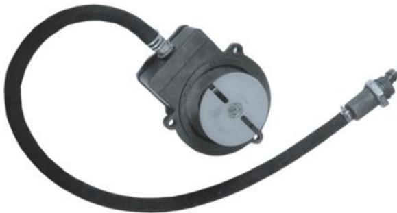
*б - Датчик угла поворота (скорости вращения колесной пары)*
