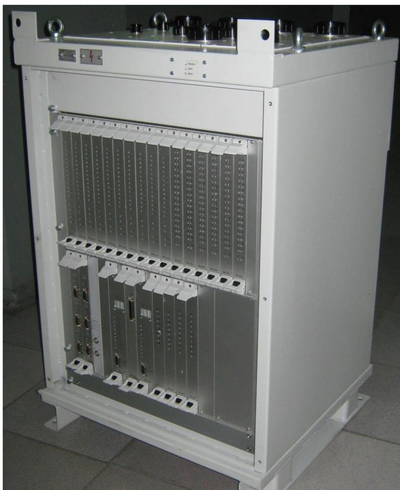
*г - МСУД (два полукомплекта) производства ЛЭС в электрическом шкафу электровозов 2ЭС5К, 3ЭС5К и других электровозов производства НЭВЗ*
