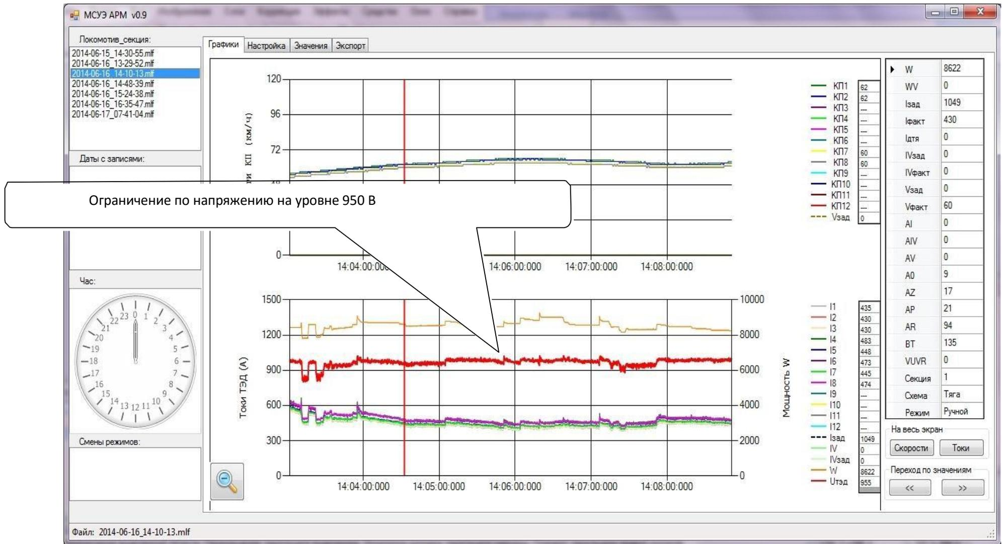
**Рисунок 5.7 – Ограничение напряжения на ТЭД на уровне 950 В: с ростом напряжения управления  $U_{УПР}$  не происходит рост напряжения на ТЭД  $U_{ТЭД}$**
