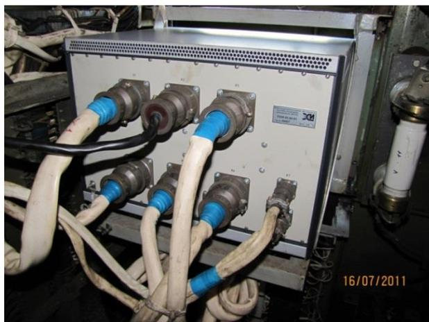
*б – подключение МСУЭ к цепям электровоза системой кабелей*
