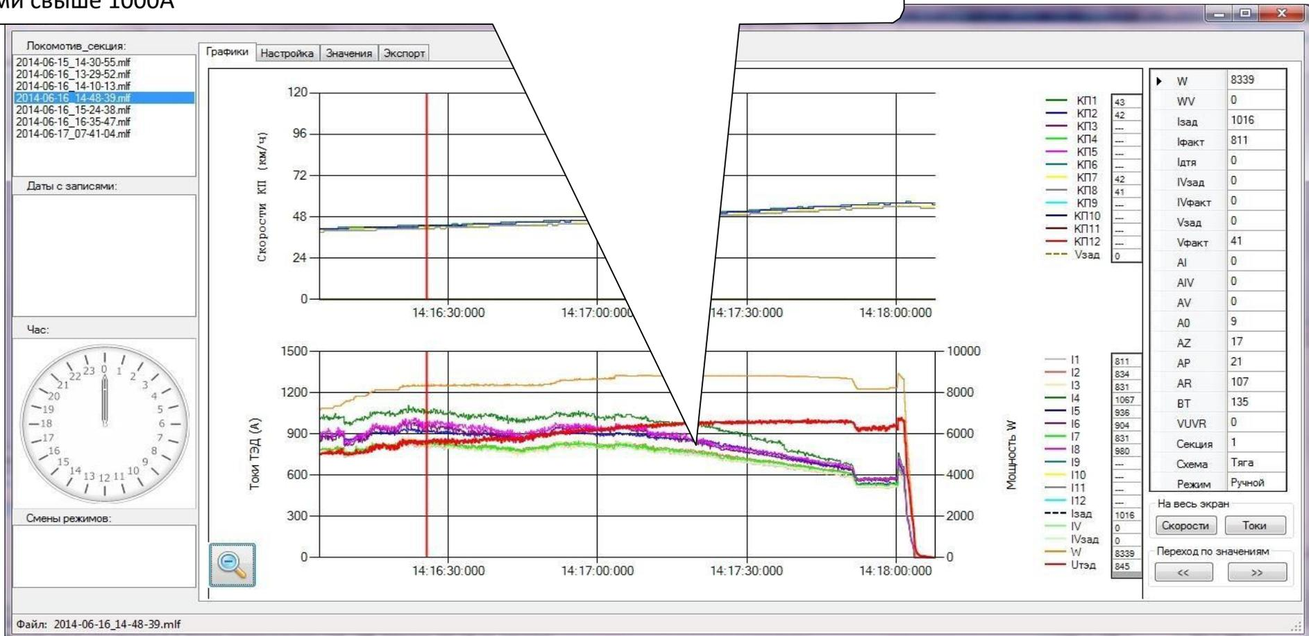
Рисунок 5.9 – Защита электровоза от перегрева ТЭД
