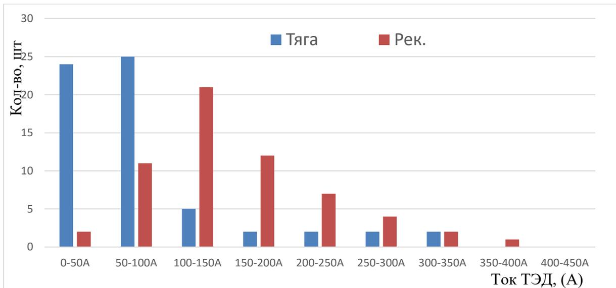
**Рисунок 4.16** – Распределение разброса токов по 61-му электровозу
