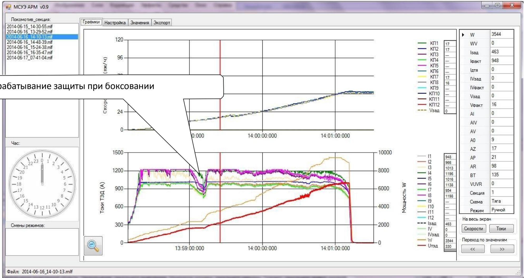
Рисунок 5.10 – Защита от боксования и перегрева
