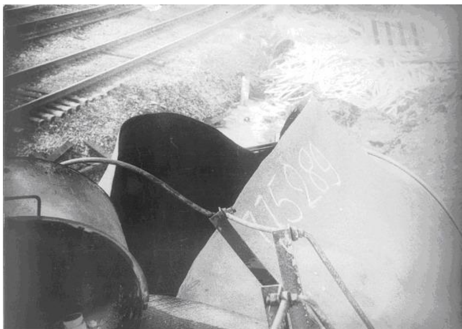
Рисунок 1 – Последствия нахождения котла цистерны в очаге пламени
