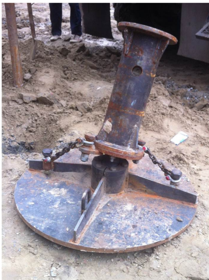
Рисунок 2.6 – Штамп площадью 5\,000\text{ см}^2 , используемый при экспериментальных исследованиях
