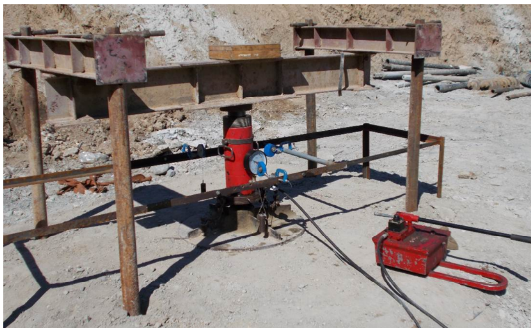
Рисунок 2.7 – Установка штампового испытания
