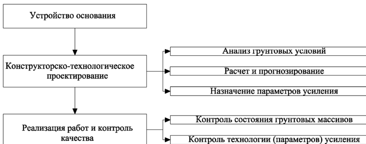
Рисунок 4.1 – Схема устройства усиленных грунтовых оснований
