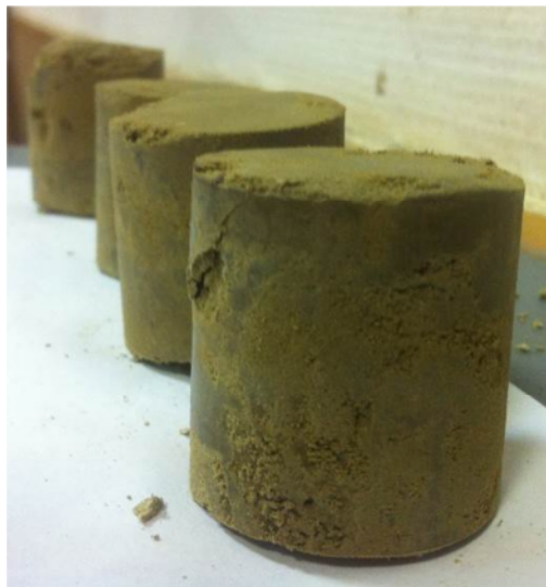
Рисунок 2.5 – Образцы материала набивных свай перед испытанием на одноосное сжатие
