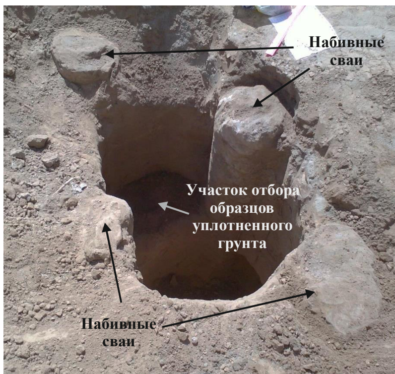
Рисунок 2.11 – Шурф, вскрытый около набивных свай
