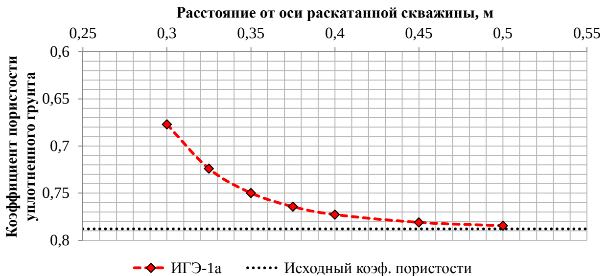
Рисунок 4.9 – Расчет изменения коэффициента пористости грунтов ИГЭ-1а при их уплотнении раскаткой
