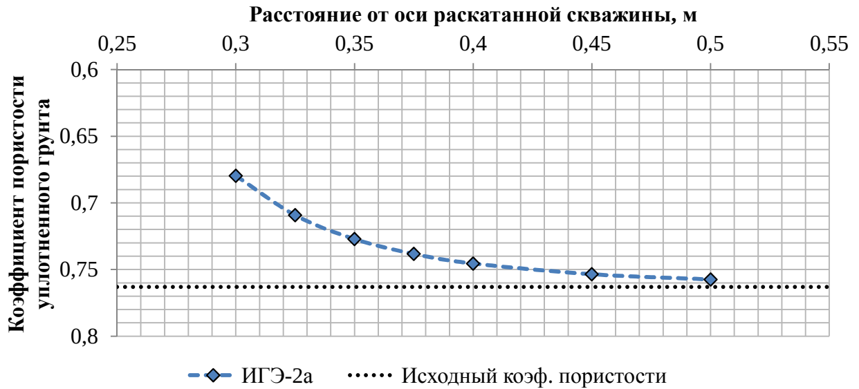
Рисунок 4.8 – Расчет изменения коэффициента пористости грунтов ИГЭ-2а при их уплотнении раскаткой скважин
