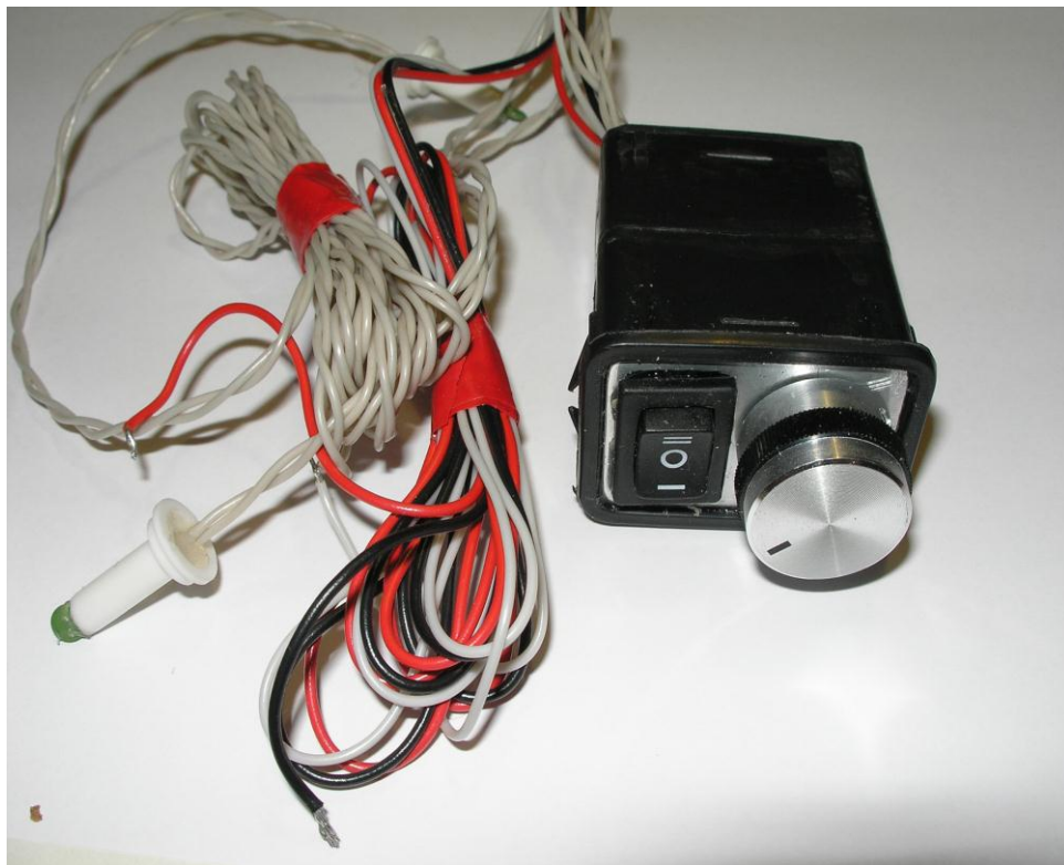
Рисунок 3.29– Автоматический регулятор частоты вращения вентилятора отопителя
