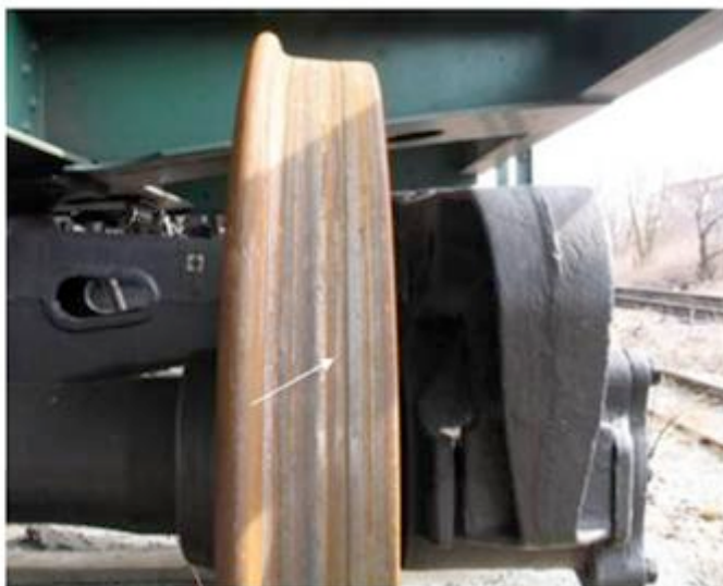
Рисунок 1.3 - Кольцевые выработки на поверхности катания колес
