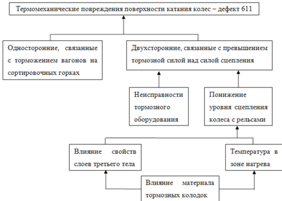
Рисунок 1.13 - Причины образования термомеханических повреждений поверхности катания колес
