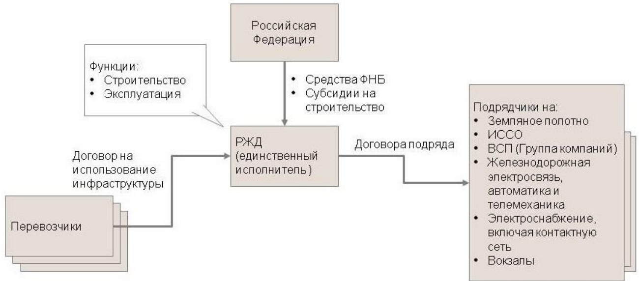
Рисунок 3.6 – Схема реализации пилотного участка корпоративно-концессионного механизма проекта (Источник: ОАО «Скоростные магистрали»)
