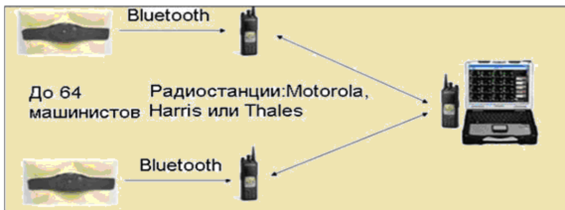
Рисунок 1.7 - Приборы комплекса мониторингового контроля психофизиологического состояния машиниста локомотива
