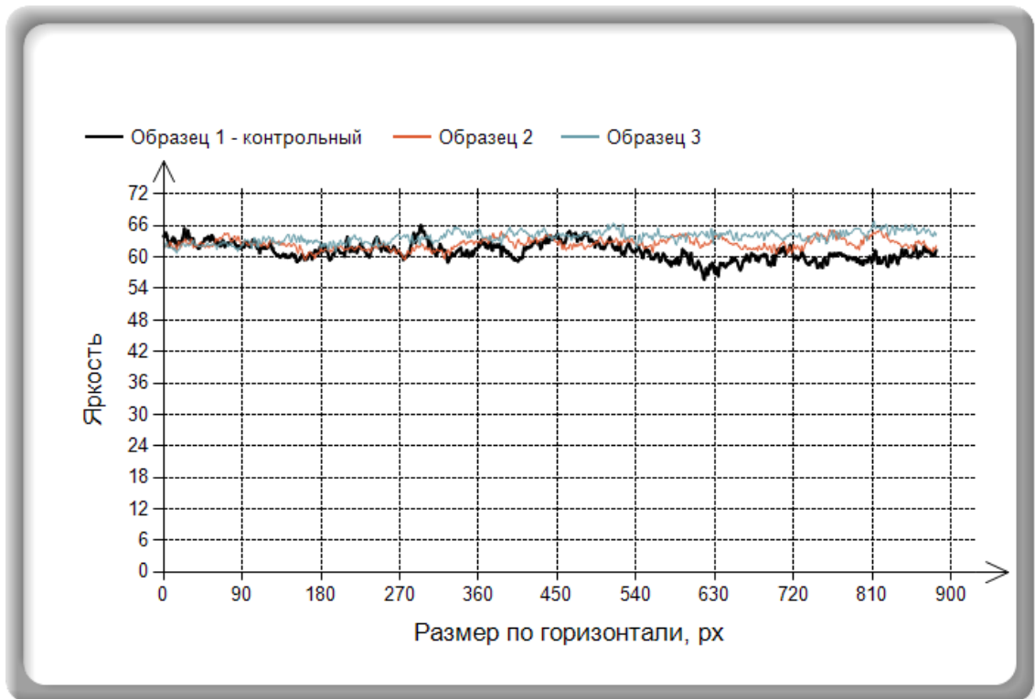
Рисунок 6.30 – Средняя яркость по ширине образца ЭД-20+АФ-2+ портландцемент
