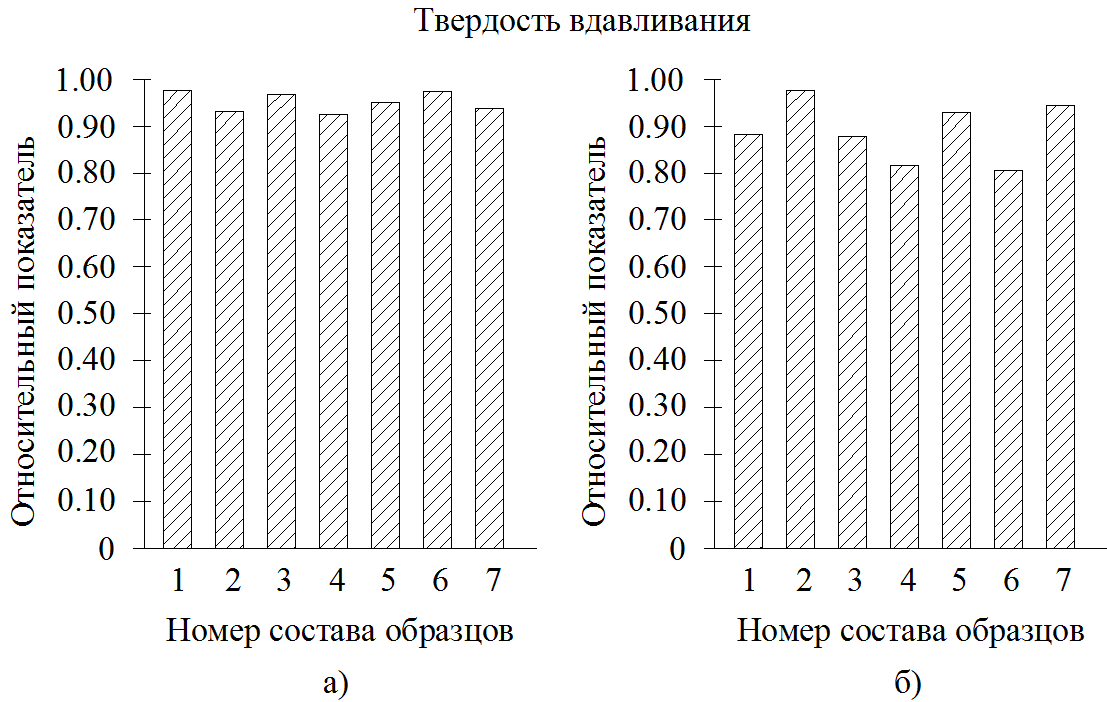
Рисунок 6.33 – Сравнение твердости вдавливания: а) образцы на открытой площадке; б) образцы под навесом
