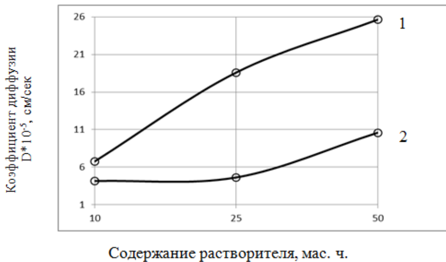
Рисунок 4.17 – Зависимость изменения коэффициента диффузии эпоксидных композиций от содержания бутилового спирта: 1 – составы, на основе смолы марки ЭД-20; 2 – составы, на основе смолы марки LE-828
