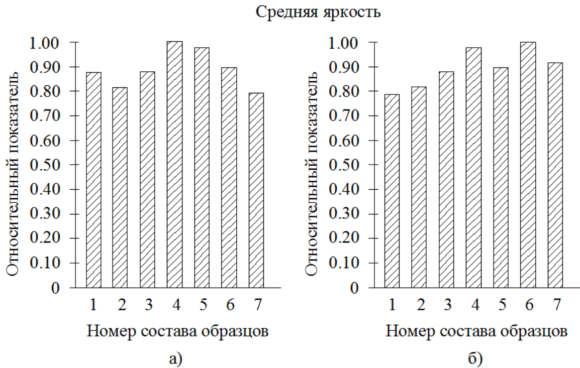
Рисунок 6.35 – Сравнение средней яркости: а) образцы на открытой площадке; б) образцы под навесом
