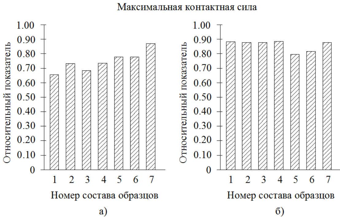
Рисунок 6.34 – Сравнение максимальной контактной силы: а) образцы на открытой площадке; б) образцы под навесом
