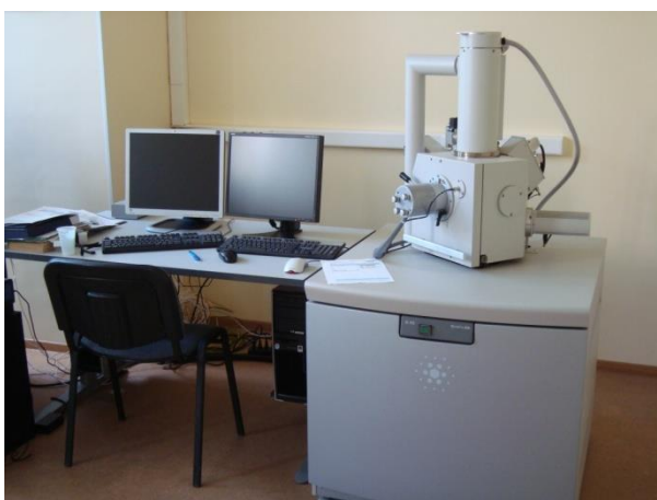
Рисунок 2.2.1 - Растровый электронный микроскоп-микроанализатор Quanta 200 (Швейцария), оснащённый системой микроанализа Apollo 40 (Phillips, Голландия).
