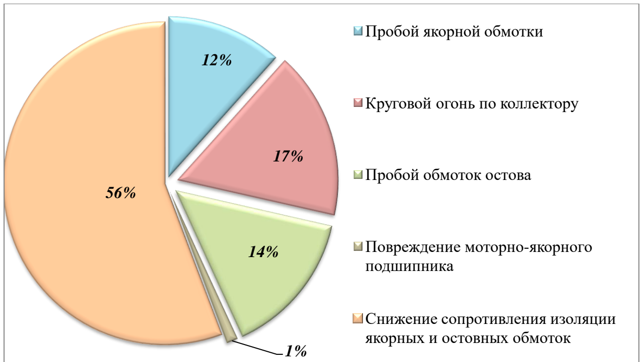
Рисунок 1.28. Распределение отказов ТЭМ электровозов 2ЭС6 по видам неисправностей
