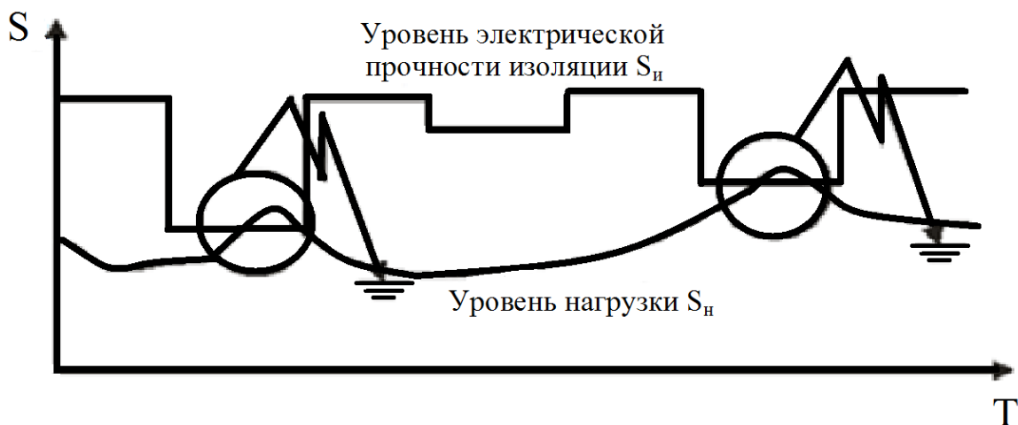
Рисунок 3.13. Пробой изоляции ТЭМ вследствие снижений электрической прочности изоляции из-за переувлажнения
