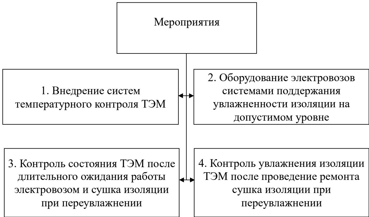
Рисунок 4.1. Мероприятия по предотвращению выдачи на линию электровозов с переувлажненной изоляцией ТЭМ
