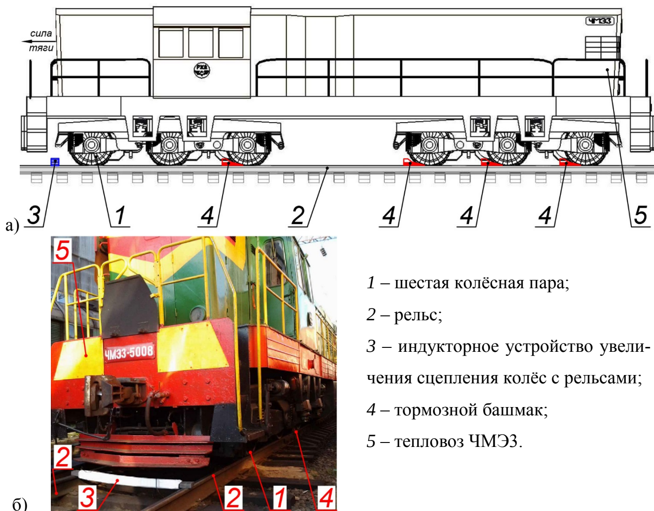
Рисунок 5.4 – Схема испытаний (а), подготовительный этап испытаний (б)
