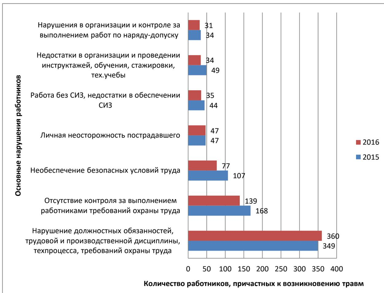
Рисунок 1.5 - Анализ основных нарушений работников ОАО «РЖД», причастных к возникновению травм на производстве
