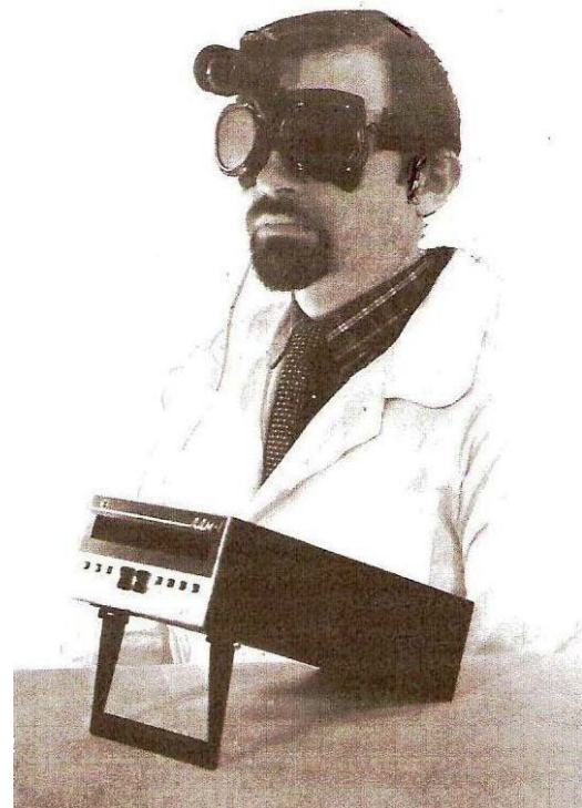
Рисунок 4.10 – Проведение индивидуального дозиметрического контроля лазерного излучения с помощью лазерного дозиметра ЛДМ-1
