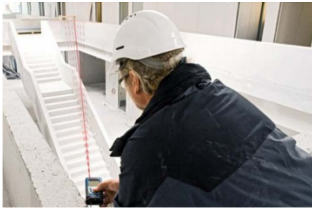
Рисунок Б.3 – Применение лазерных дальномеров-рулеток: а – в строительстве, б – в быту
