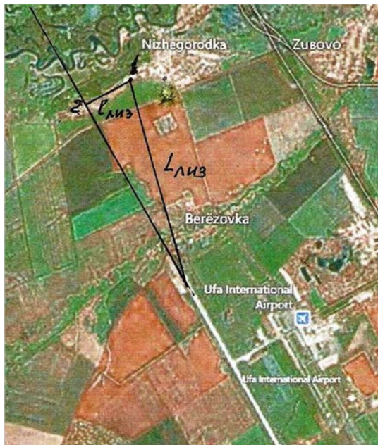
Рисунок 3.9 – Схема определения по карте параметров L_{\text{ЛИЗ}} , l_{\text{ЛИЗ}} для случая НВЛ ВС вблизи аэропорта «Уфа» (инцидент № 1 по таблице 3.2)
