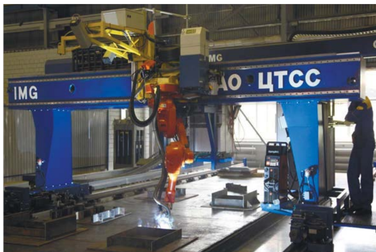
Рисунок А.2 – Работа комплекса лазерной резки, гибридной лазерно-дуговой сварки и приварки ребер жесткости к полотнищам плоских секций размерами 12×12 м
