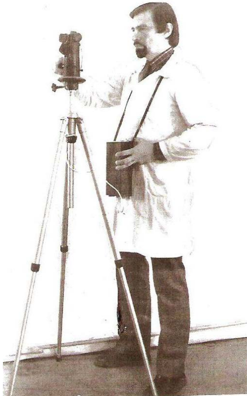
Рисунок 4.9 – Проведение предупредительного дозиметрического контроля лазерного излучения с помощью лазерного дозиметра ЛДМ-1
