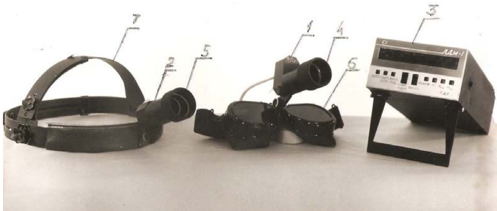
Рисунок 3.3 – Многоцелевой лазерный дозиметр ЛДМ-1: 1 – ФПУ-1; 2 – ФПУ-2; 3 – БПР; 4, 5 – сменные ослабители излучения; 6 – защитные очки; 7 – устройство для крепления ФПУ-1 или ФПУ-2 на голове оператора
