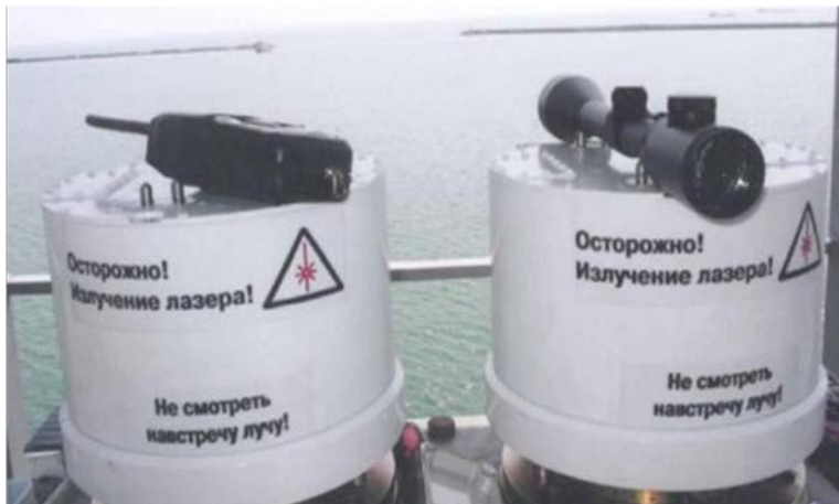
Рисунок А.9 – лазерные модули ЛСМ «Анемон-3» на верхней площадке переднего створного знака в порту г. Туапсе [12]
