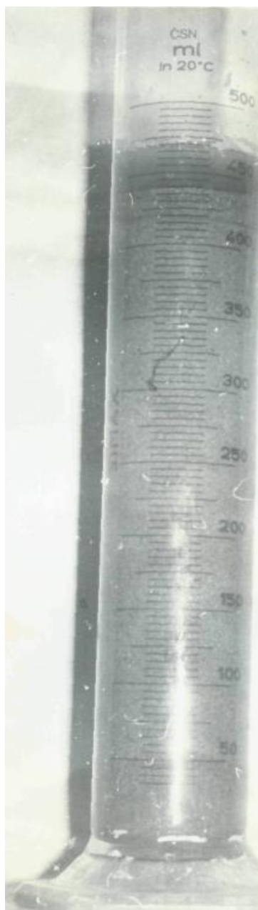
Рис. 6.5. Образец водонасыщенного песчаного грунта после осуществления операции аэрирования
