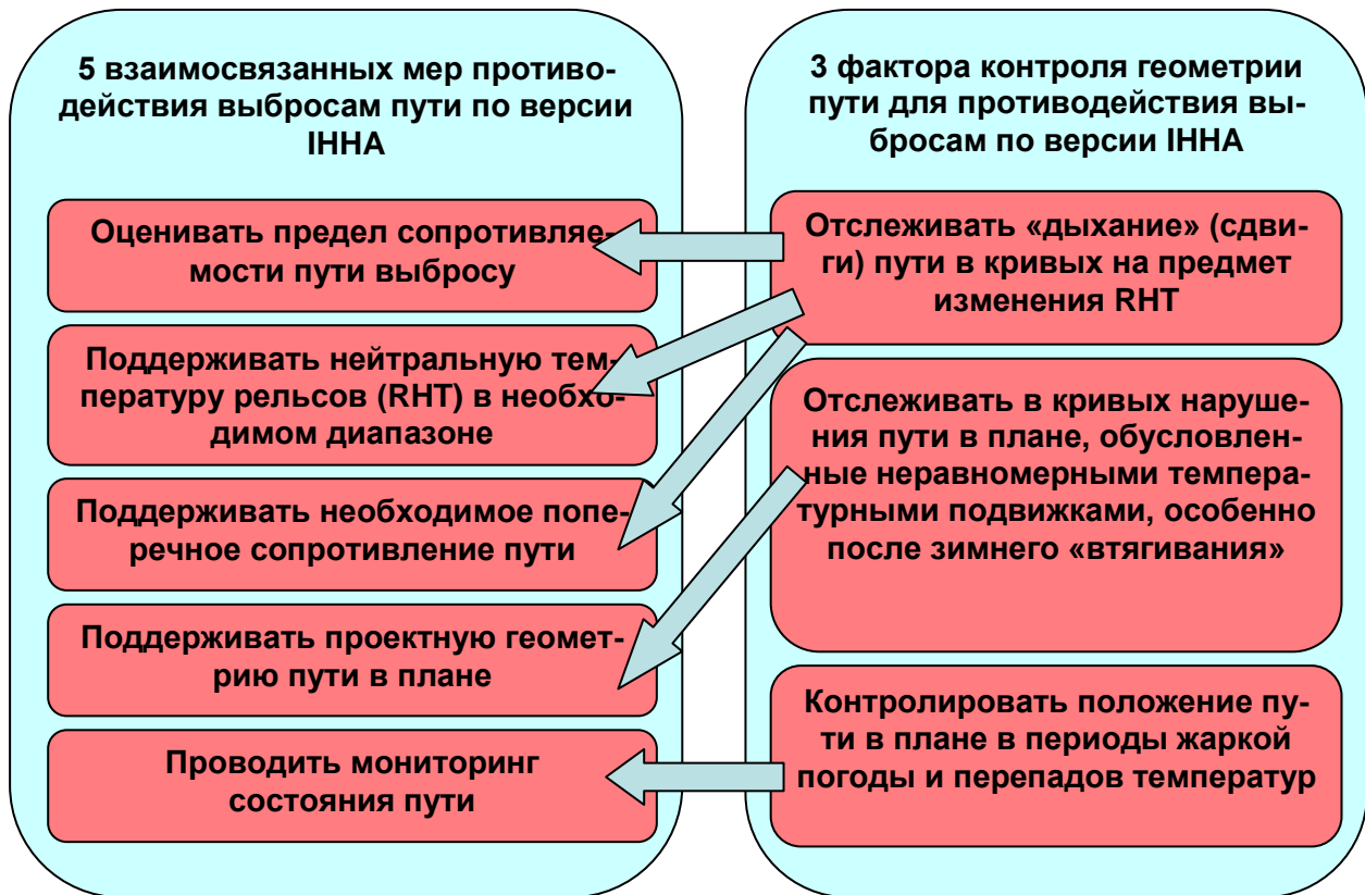
Рисунок 2.8 – Влияние геометрии пути на сопротивляемость выбросам
