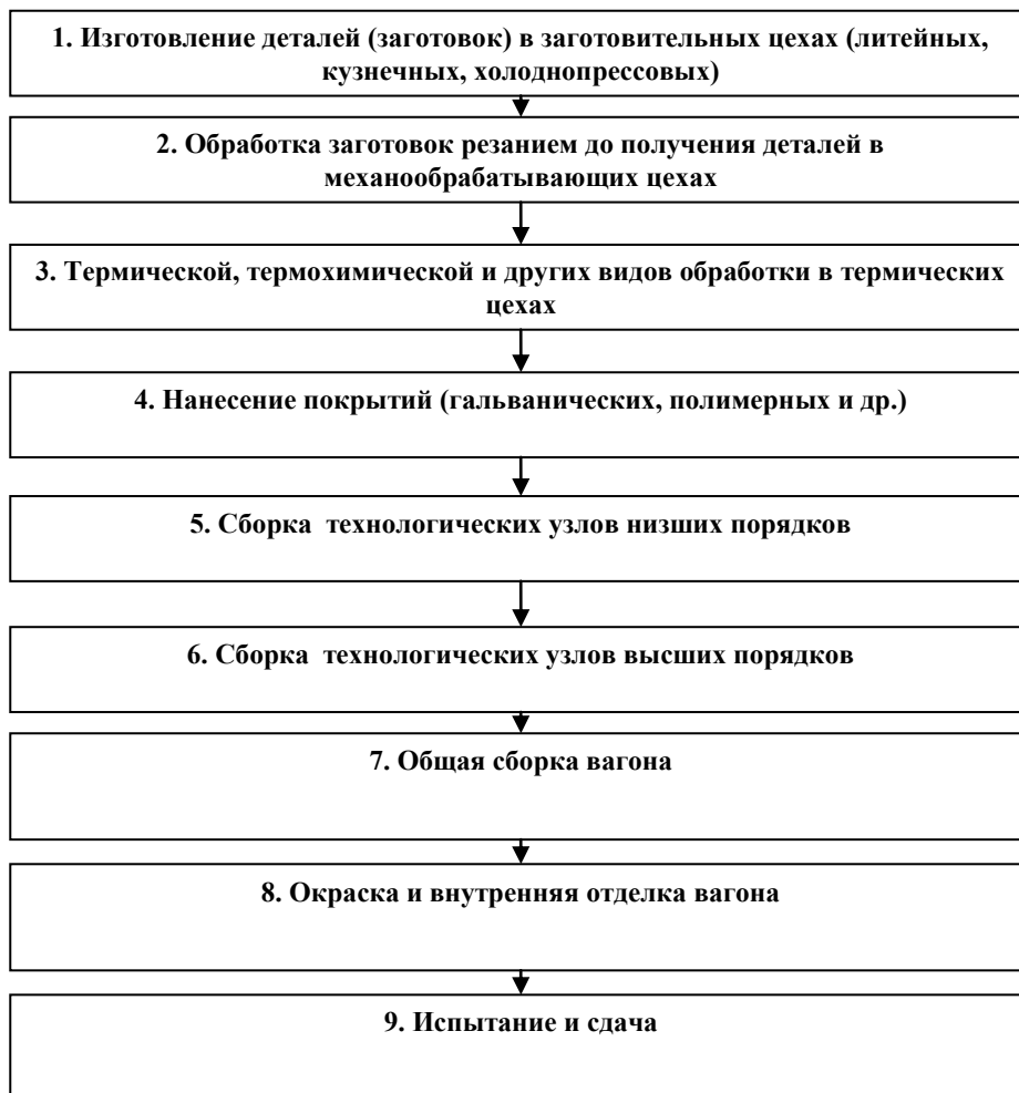
Рисунок 3.2 – Технологические операции производства грузового вагона
