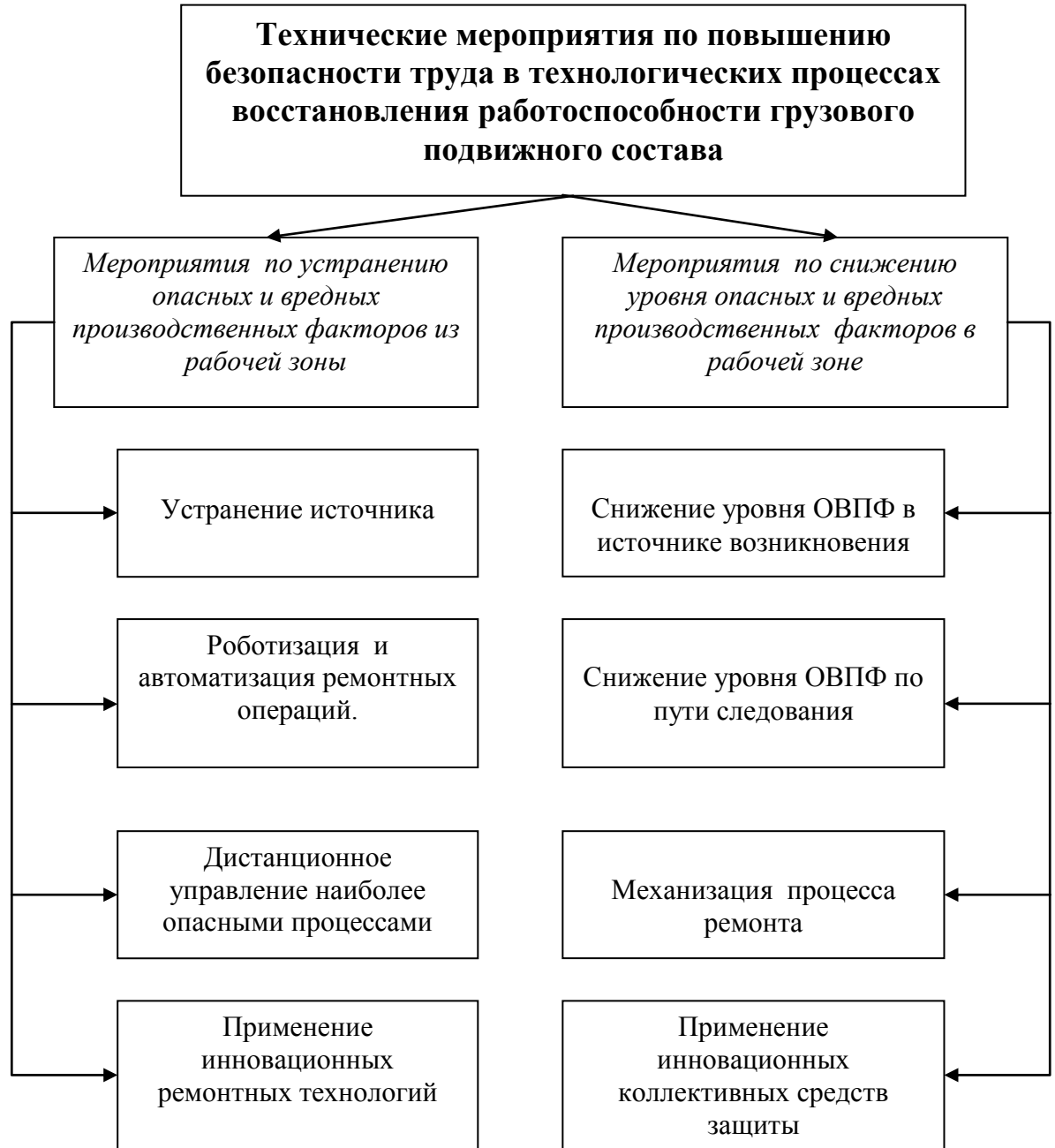
Рисунок 5.7 - Технические мероприятия, направленные на повышение безопасности труда в технологических процессах восстановления работоспособности грузового подвижного состава
