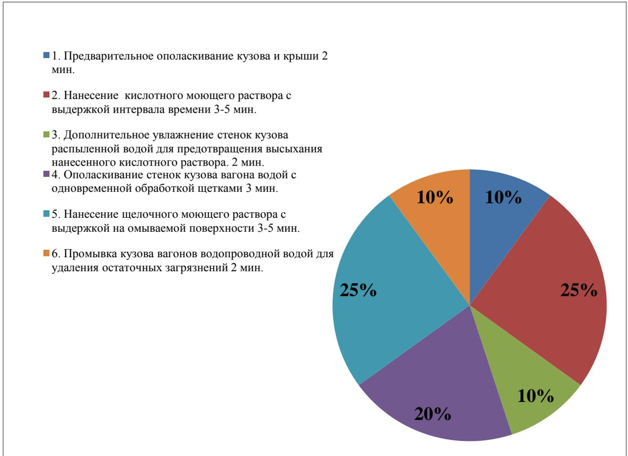
Рисунок 2.4 - Технология ручной обmyвки вагонов
