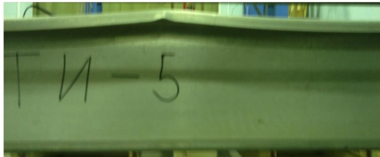
Рисунок 2. 20 — Картина деформирования испытываемых образцов
