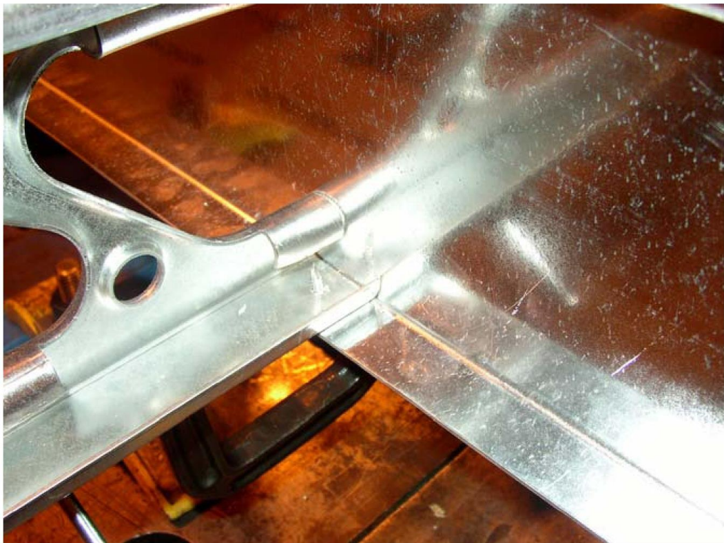
Рисунок Б.1 — Крепление образца к: а) «нижней» направляющей; б) «верхней» направляющей;
