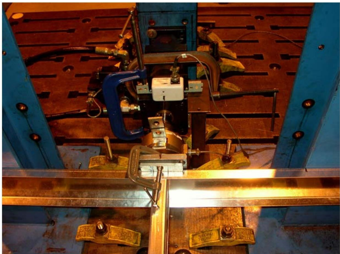
Рисунок Б.4 — Гидравлический сервопривод с датчиком перемещений
