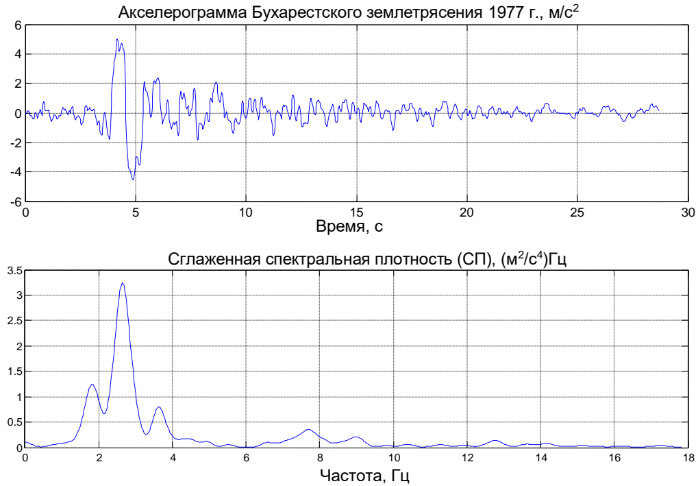
Рисунок 2.28. Акселерограмма Бухарестского землетрясения (направление N-S ) и соответствующая сглаженная спектральная плотность (метод Уэлча с 50% перекрытием окнами Хэмминга).
