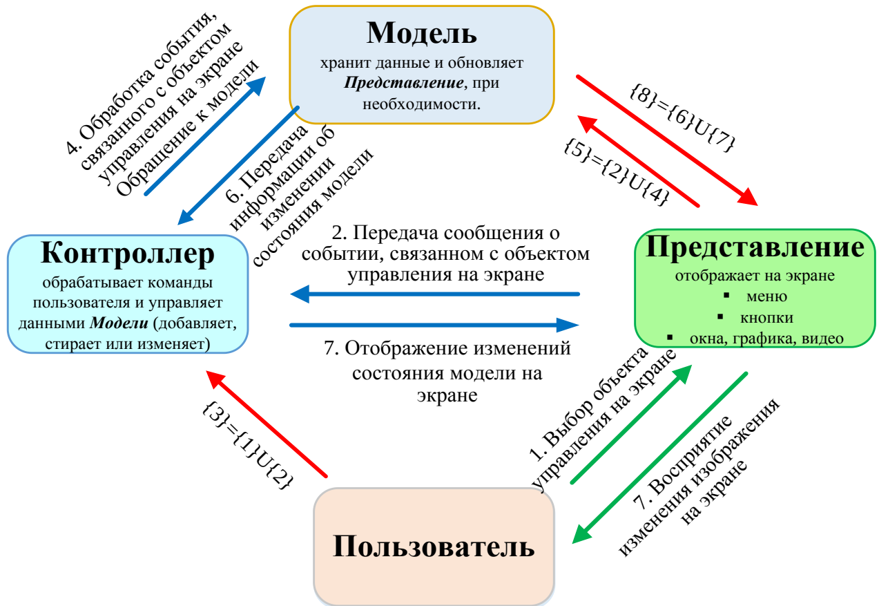
Рисунок 2.7 – Model-View-Controller (MVC, Модель-Представление-Контроллер)
