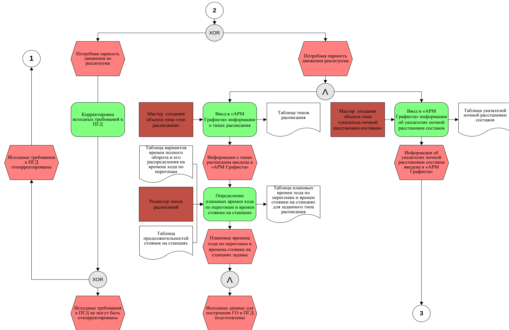
Рисунок 2.2 – Модель процесса подготовки исходных данных для автоматизированного построения ППД и ГО (продолжение)
